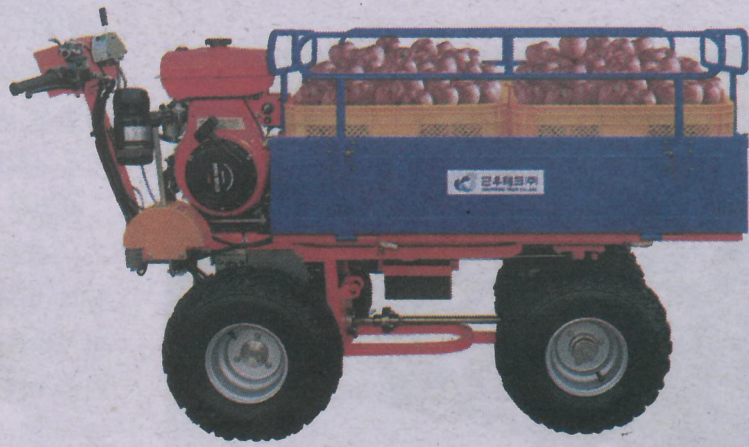
2중 차동장치 부착, 덤프·리프트 기능 선택이 가능한 ‘참센’ 4륜구동 엔진형운반차
